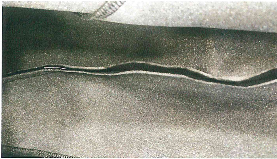
Fot. 2. Sposób przeszycia w miejscu zaprojektowanym do rozerwania na skutek detonacji poduszki gazowej Photo 2. A method of sewing in a place designed to be torn apart due to the detonation of AIR-BAG
