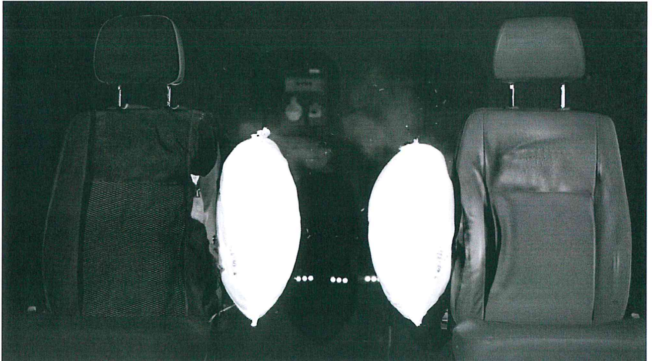
Fot. 11. Czas 9,8 ms – maksymalne napelnienie poduszek gazowych Photo 11. Time 9,8 ms – maximum filling of AIR BAGS
